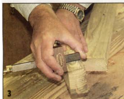
Шипы на концах перемычек размечают рейсмусом.
