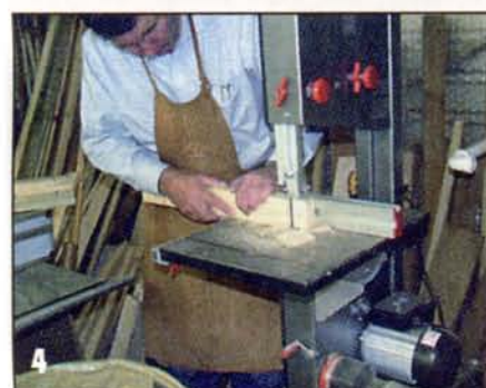
Шипы на концах перемычек выпиливают ленточной пилой или мелкозубой ножовкой.
