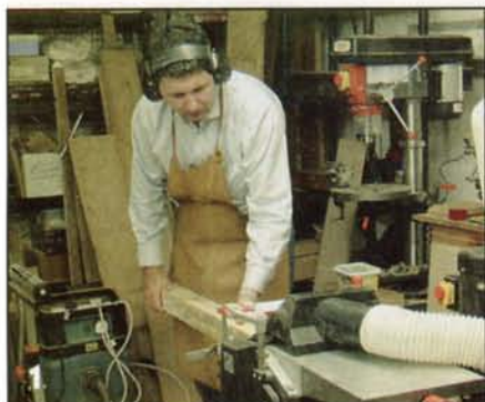
Для начала грубо обработанные брусья надо прострогать.
