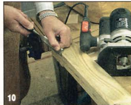
Чтобы стойки смотрелись изящнее, на их рёбрах снимают фаски.
