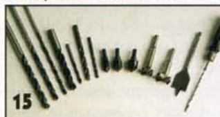
Слева направо: 5 спиральных свёрл по дереву, 2 универсальных спиральных свёрла, 3 зенкера, 2 свёрла Форстнера, перовое сверло и ручной буравчик.
