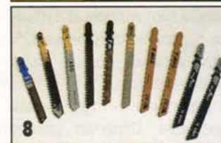
Чтобы использовать все возможности лобзика, нужно иметь самые разные пилки для него.
