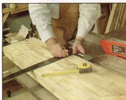
Уложив стойки на верстаке, размечают на них все пазы.
