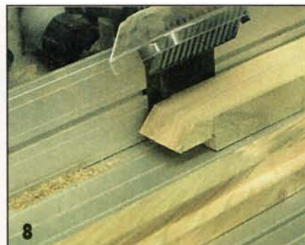
На тыльной стороне верхних и нижних перемычек выпиливают фальцы для досок обшивки.
