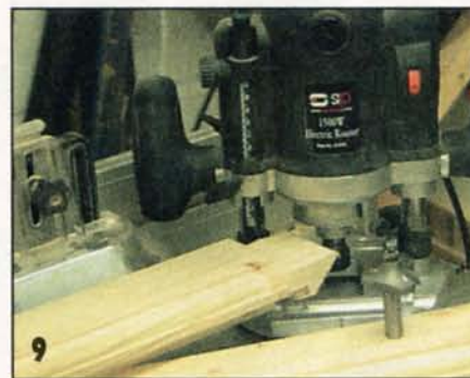
Для красоты рёбра боковых перемычек можно скруглить.
