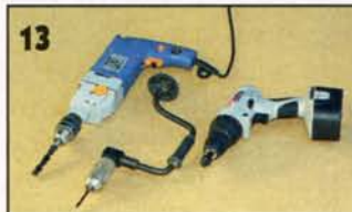
Слева направо: дрель, коловорот, аккумуляторный шуруповёрт.
