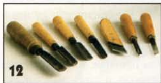
Слева направо: полукруглые стамески, нож-косяк, стамеска-уголок и плоская стамеска.
